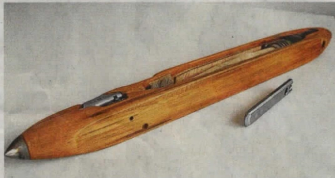
Geschichte und Moderne: Früher gab es das Web-Schiffchen, in den modernen Maschinen kommt das kleine Projektil zum Einsatz. Fotos: jl
